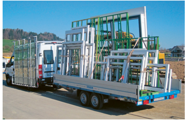
4 Das Transportfahrzeug muss für den Transport geeignet und auf die eingesetzten Hebemittel abgestimmt sein.
