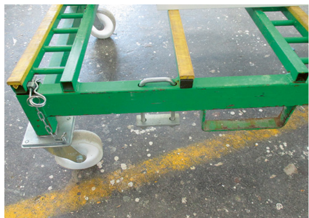
2 Transportgestell mit demontierbaren Rädern, Krananschlagpunkten und Gabelzinkenlaschen (für Staplertransport)
